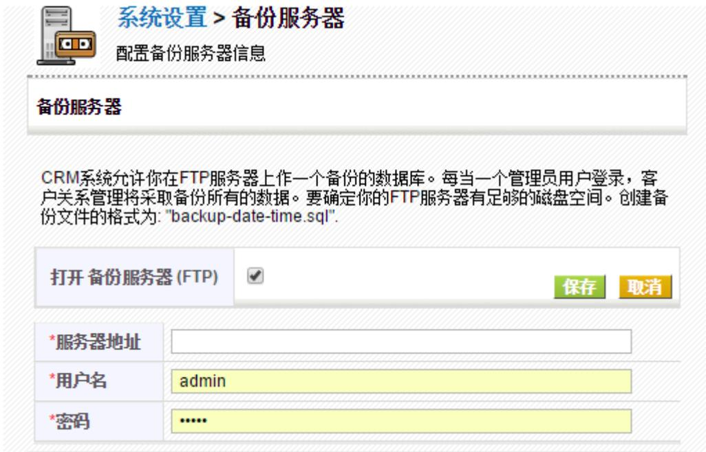
打开备份服务器功能，输入 FTP 服务器地址，手工备份。**备份路径请建立一个空的新文件夹进行备份，文件夹请勿使用中文名称**
